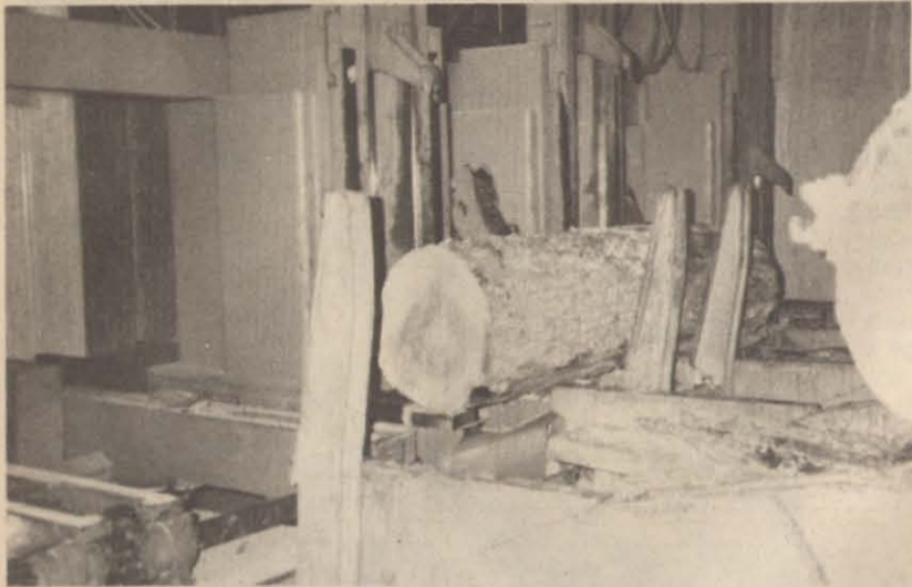
Chargement automatique d'une grume.
