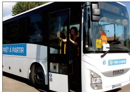
**Lorsque la porte est coincée parce que l'électricité est coupée, on doit appuyer manuellement sur le bouton rouge pour l'ouvrir. On doit attendre que la porte soit descendue pour la pousser.**
