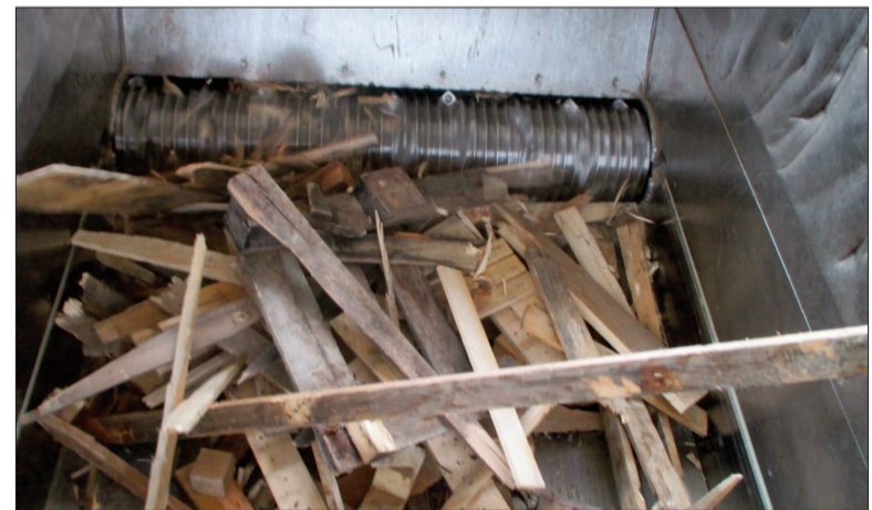
Le broyage du bois "propre" : il ne doit ni être peint, ni verni, ni encollé...
