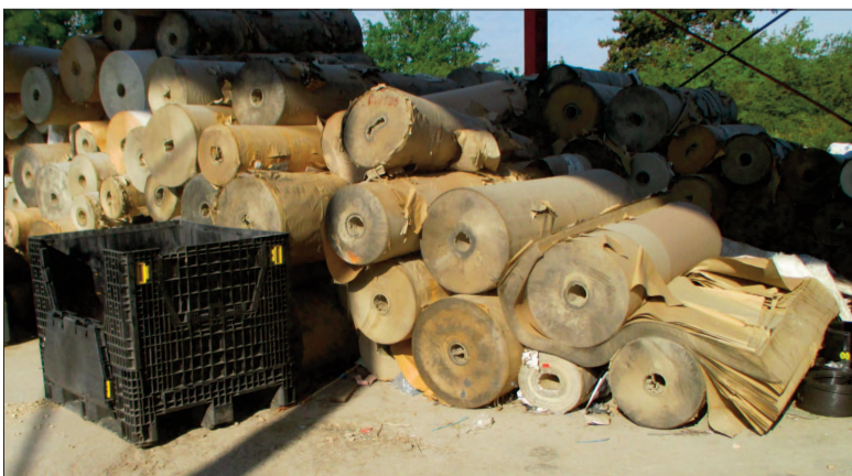
Le papier qui arrive en rouleau n'est pas recyclable en l'état. Il doit donc être déroulé, mis en feuilles avant d'être transformé. L'équipe d'Emmaüs s'en charge.
