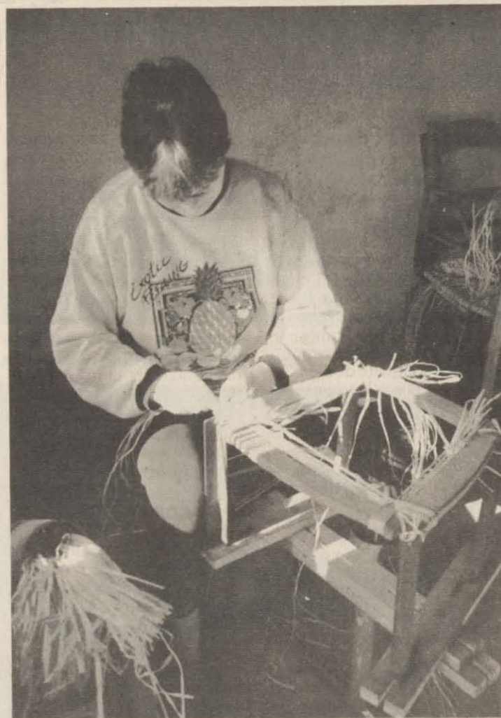
Paillage sur châssis démontable.
