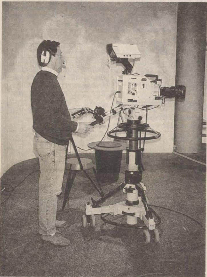
Caméra n° 1, le conducteur d'émission fixé sous l'écran de contrôle.
